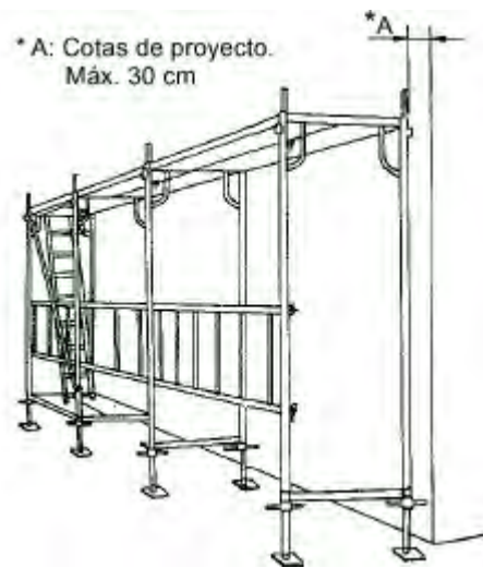
Encadenado del andamio y comprobación de la separación de fachada
