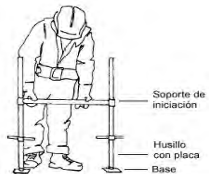
Introducción del soporte de iniciación en los husillos con placa
